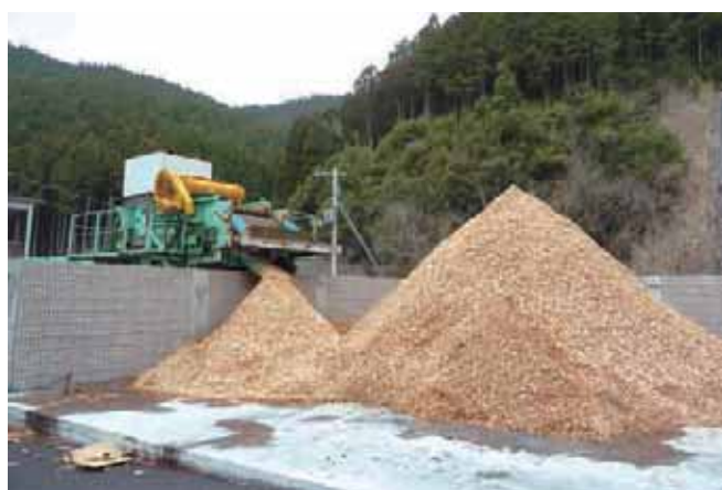
中間土場に併設されたチップ製造ライン
