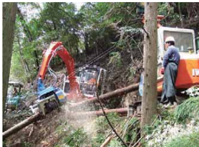
スイングヤーダ（手前）、プロセッサ（奥）、フォワーダの3点セットで素材生産力を強化する
