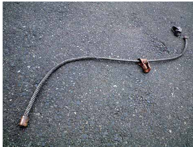
チョーカーワイヤの中を通っているのがチョーカースライド (右上の金具がロープフック)
