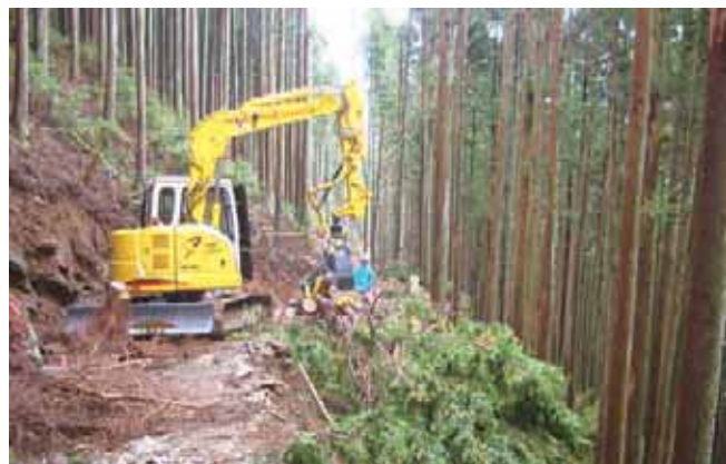
高密路網を整備し、ウィンチ付きグラップルで伐倒木を引き出す
