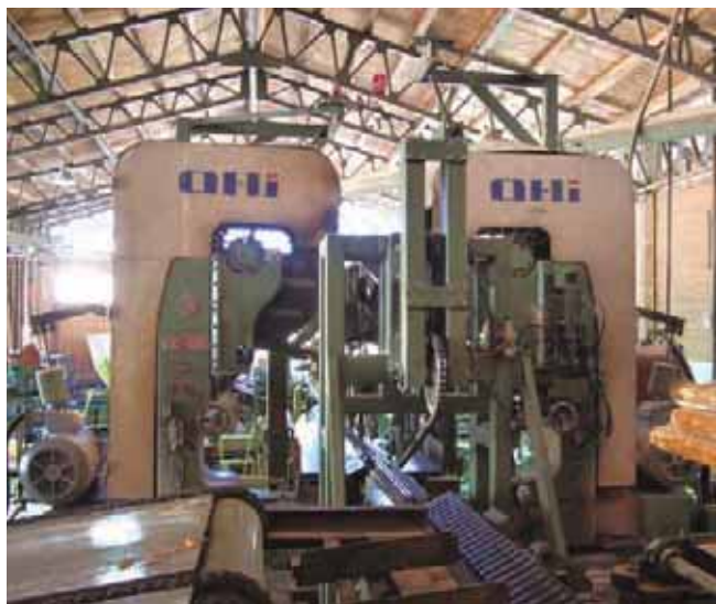
ツインバンドソー。 独自のライン配置でワンウェイ製材を実現している
