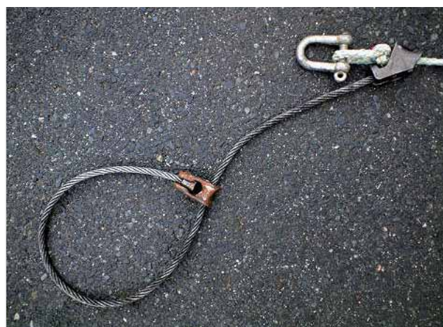
繊維ザイルが右に動くとき荷を掛けた輪がしまる仕組みだ
