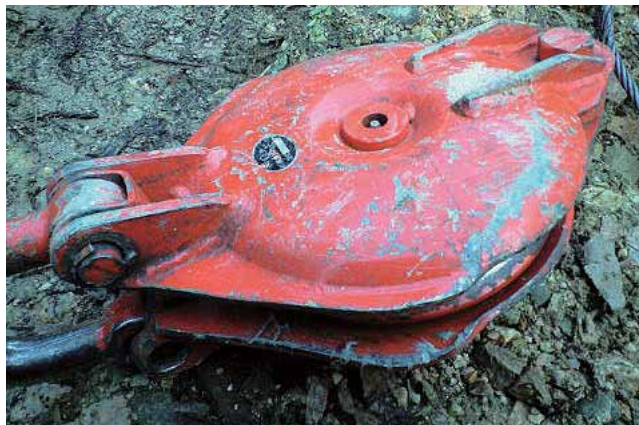
繊維ザイルが損傷し、その一部が滑車に付着している。 繊維ザイルと同じ材質でできた滑車に変えるなどの対策が必要
