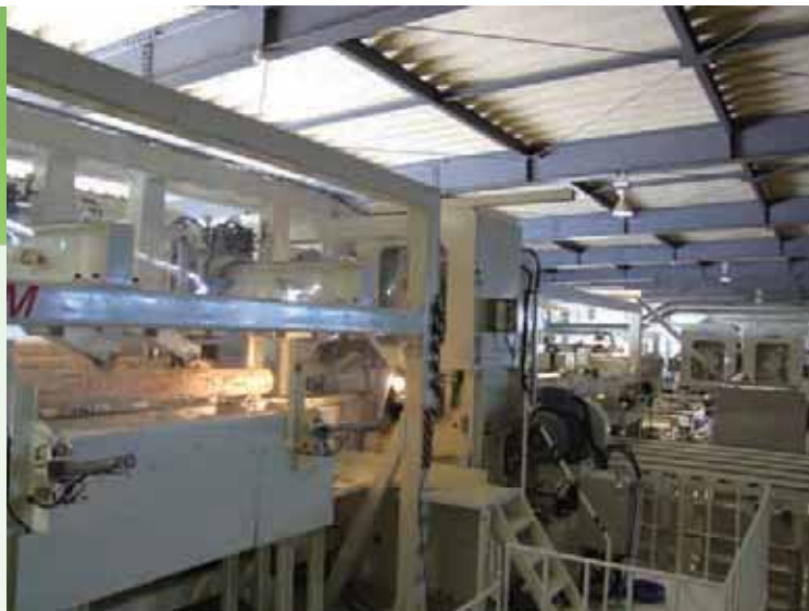
ワンウェイ方式の高速製材システム。 手前と右奥に2基のツインバンドソーが配置されている
