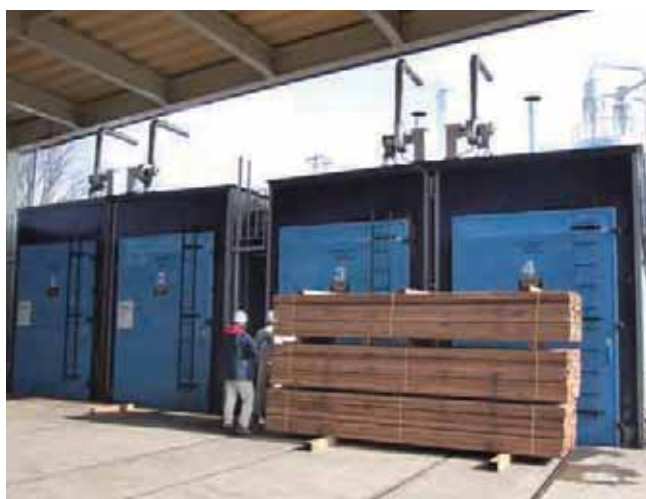
高温蒸気式乾燥機
