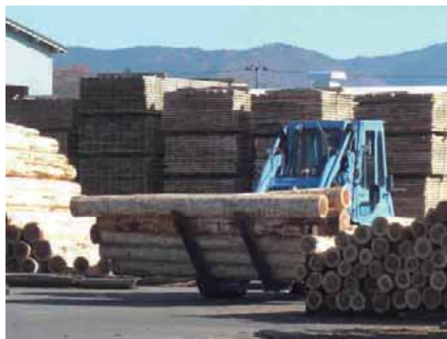
皮剥ぎ丸太の運搬（沓澤製材所）
