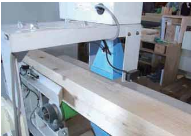
ラインに組み込まれた含水率計測器
