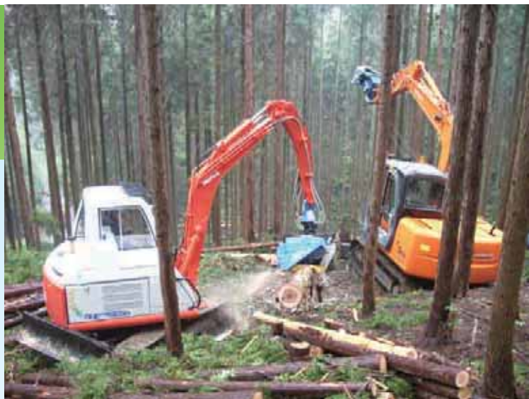
スイングヤーダによる集材とプロセッサによる造材のセット作業
