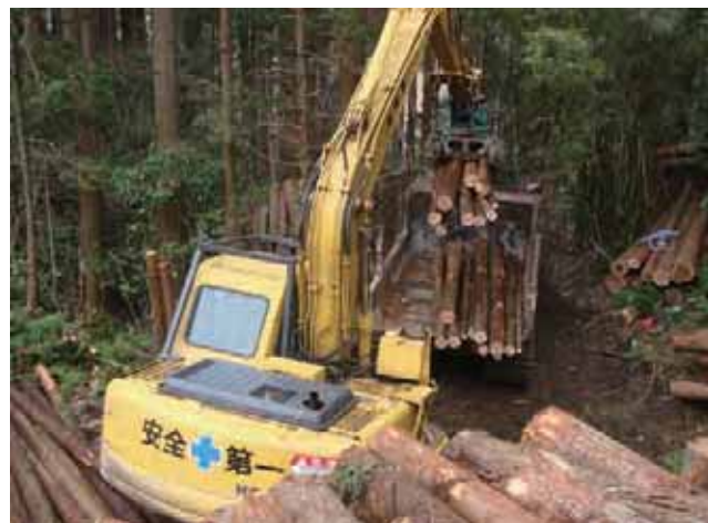
フォワーダによる搬出作業
