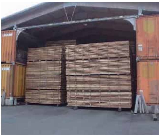
久万広域森林組合の大型製材工場ではスギ間柱を主体に生産している
