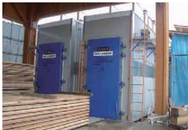
大館北秋田森林組合の減圧蒸気式乾燥機
